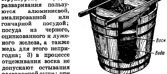
Рис. 10. Способ отцеживания воска из разваренного воскового сырья.
